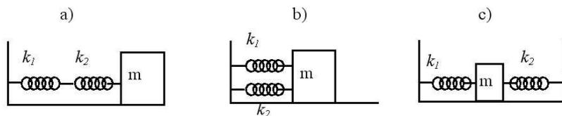
SOL:  $T = \frac{2\pi}{\omega}$ ,  $\omega = \sqrt{\frac{k_{eq}}{m}}$  con a)  $k_{eq}^{-1} = k_1^{-1} + k_2^{-1}$ , b)  $k_{eq} = k_1 + k_2$ , c)  $k_{eq} = k_1 + k_2$ .
