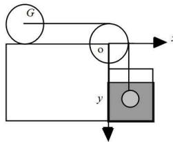
$$\text{SOL: } \ddot{y} + \frac{b}{2M+m} \dot{y} = \frac{mg}{2M+m}.$$
