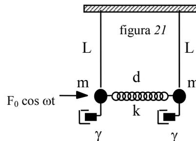
**11.3** Encontrad las ecuaciones del movimiento de dos péndulos simples de longitud  $L$  y masa  $m$ , separados una distancia  $d$  y acoplados mediante un muelle sin masa y constante elástica  $k$  (figura 20). Considérese la longitud del muelle destensado igual a  $d$ . Obtened los modos normales de vibración e interpretarlos físicamente.
