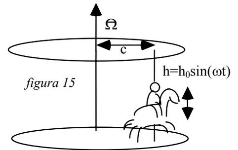
(solución  $\vec{v} = -c\Omega \sin \Omega t \vec{i}' + c\Omega \cos \Omega t \vec{j}' + h\omega \cos \omega t \vec{k}'$  y  $\vec{a}' = -c\Omega^2 \cos \Omega t \vec{i}' - c\Omega^2 \sin \Omega t \vec{j}' - h\omega^2 \sin \omega t \vec{k}'$  ambos en la base del sistema inercial. b)  $\vec{r}'_{cil} = c\vec{u}_r + h \sin \omega t \vec{u}_z$ ).
