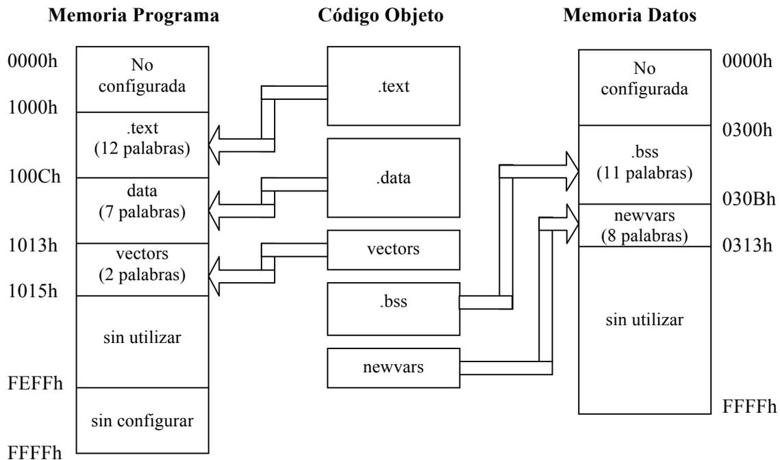
Mediante las directivas del *enlazador* se puede particularizar la relocalización de secciones al mapa de memoria del sistema. Estas directivas se localizan en un fichero de comando del *enlazador*. Siguiendo con el ejemplo anterior, la nueva especificación dada por el fichero de comando del *enlazador* sería:
