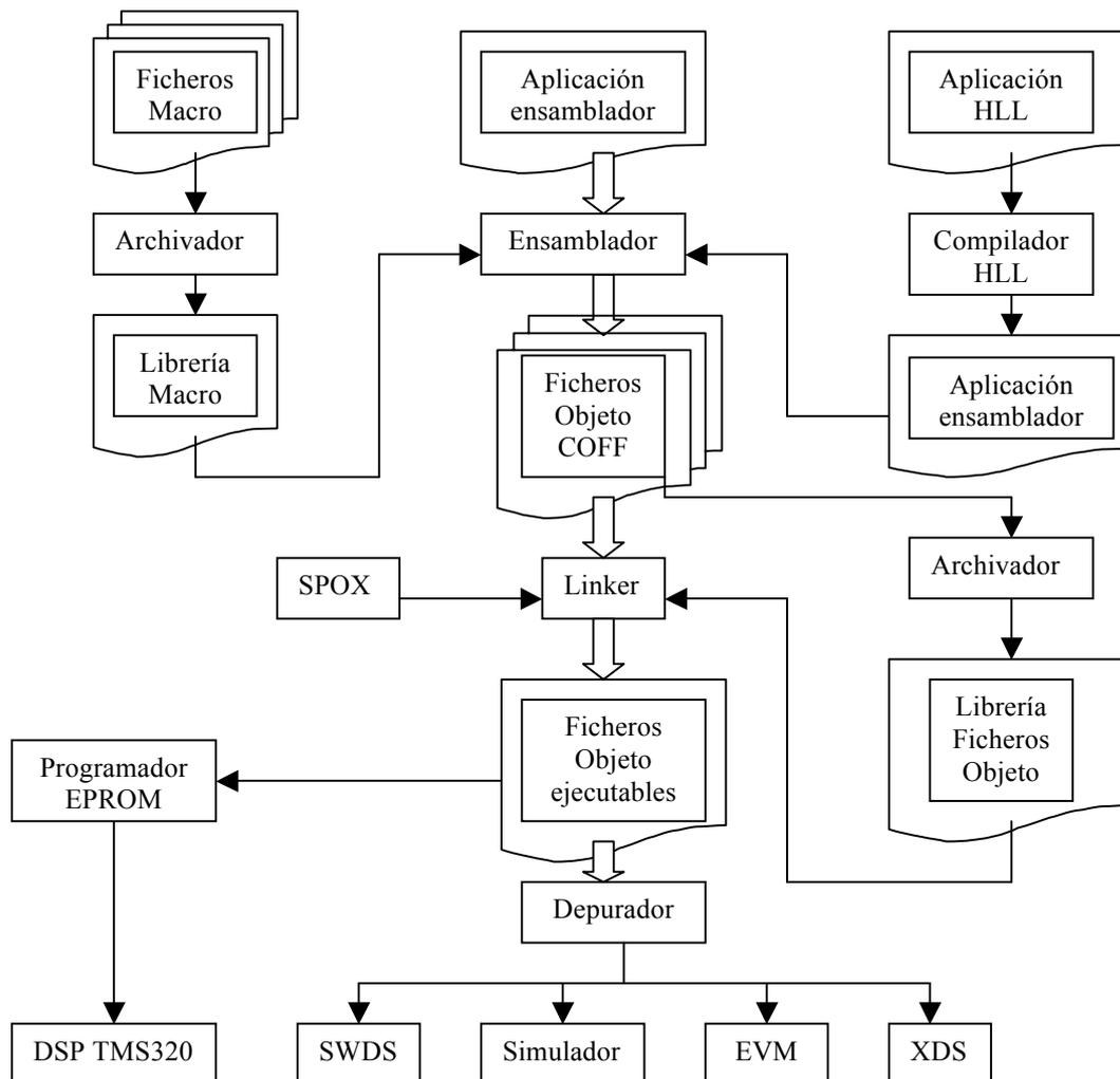
De las distintas herramientas, vamos a utilizar el ensamblador y el enlazador, para generar el código ejecutable por el DSP, y el simulador para depurar y ejecutar ese código.
